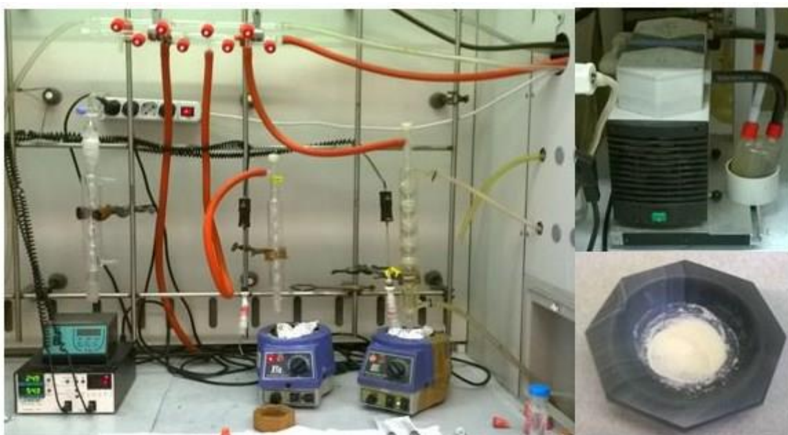
Figura 2.5 Schema delle apparecchiature usate durante il processo di sintesi e polveri finali di titanati.
