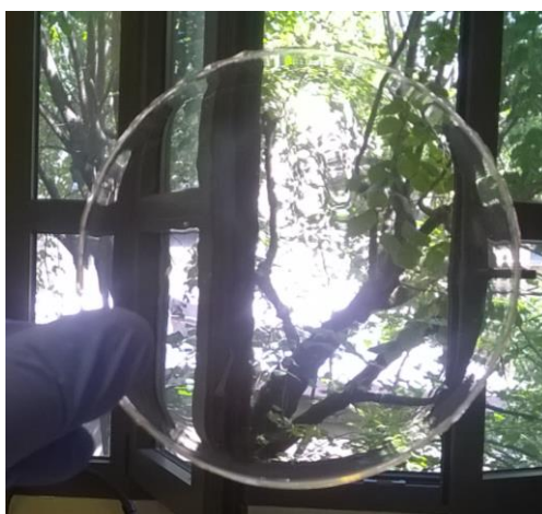
Figura 1.5 Film free standing di seta ottenuto per drop casting (§3.2.1) su una superficie di PDMS; si può notare la trasparenza e la superficie planare del campione. Il diametro del campione è di 8 cm (diametro del petri).
