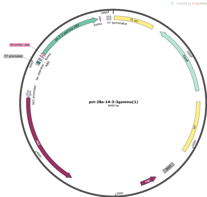
Fig.5 Struttura del plasmide pET28a
