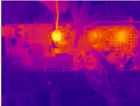
Figura 52: La camera termica mostra come l'induttanza sia il componente critico per quanto riguarda il surriscaldamento. Durante il funzionamento della scheda a tensioni non ancora massime supera infatti i 100^{\circ}\text{C} a differenza degli altri componenti.
