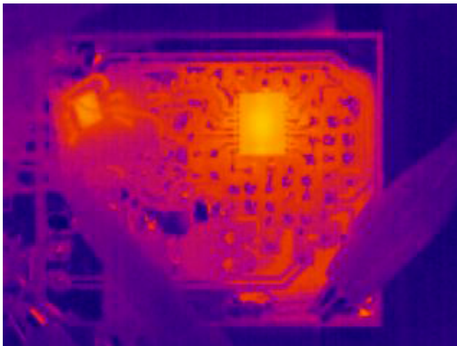
Figura 53: La parte di controllo vista con la termocamera. Si nota che i componenti piú caldi sono i due integrati, anche se mantengono temperature accettabili.
