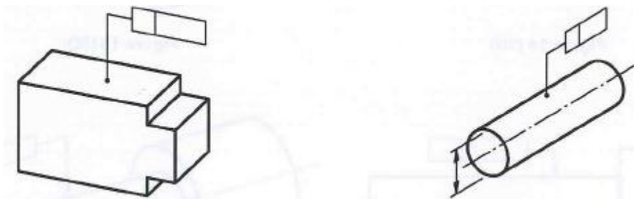
Figura 5.4 Esempio di leader line terminante con un punto
