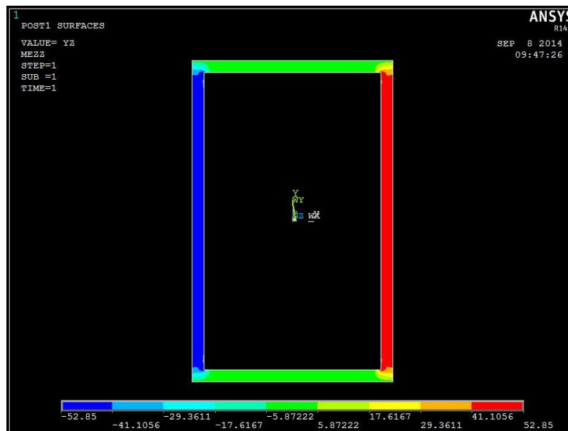
Figura 4.6. Contour Plot tensione \tau_{yz} in mezzeria su trave da 3 mm
