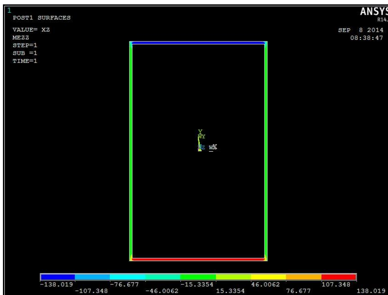
Figura 4.1. Contour Plot tensione \tau_{xz} in mezzeria su trave da 1 mm
