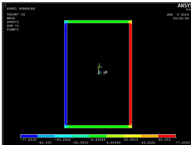
Figura 4.4. Contour Plot tensione \tau_{yz} in mezzeria su trave da 2 mm
