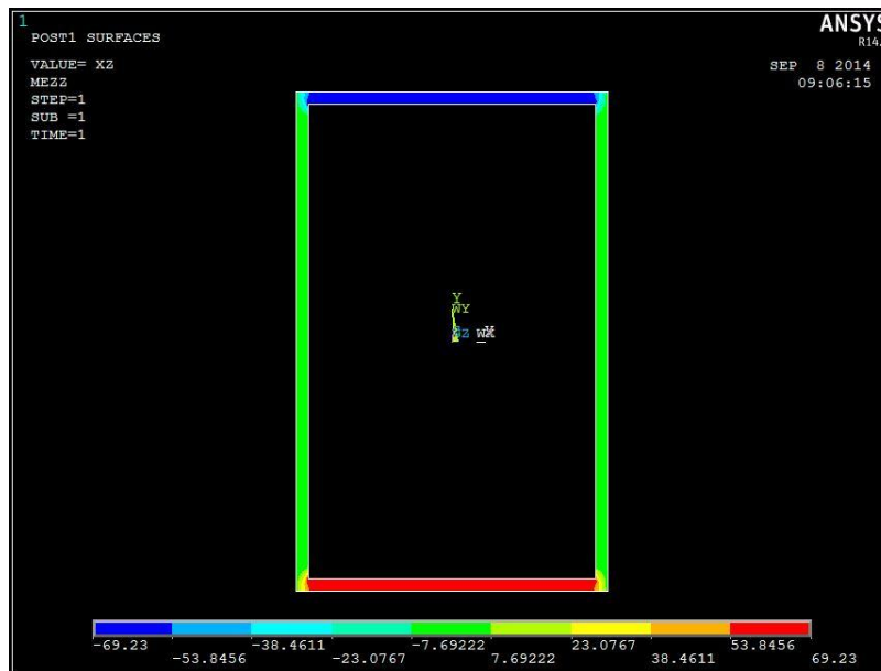
Figura 4.3.Contour Plot tensione \tau_{xz} in mezzeria su trave da 2 mm
