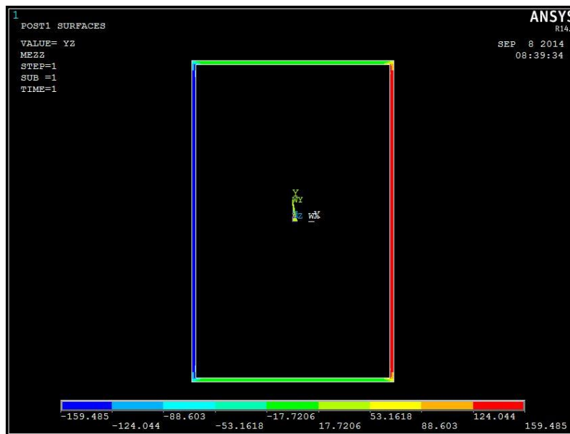
Figura 4.2. Contour Plot tensione \tau_{yz} in mezzeria su trave da 1 mm
