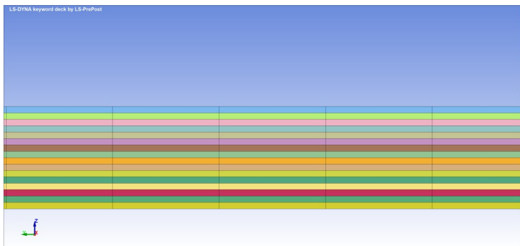
Figura 72: singole lamine modellate come elementi shell, con a video gli spessori
