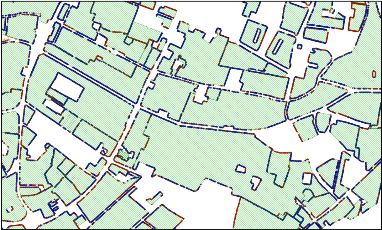
Figura 3.3. La figura rappresenta le proiezioni delle corrispondenze tra PRG e CTR sui segmenti del DBT. Le aree verdi sono le zone residenziali, le linee rosse sono le corrispondenze tra PRG e CTR, le linee blu sono le corrispondenze tra PRG e DBT
