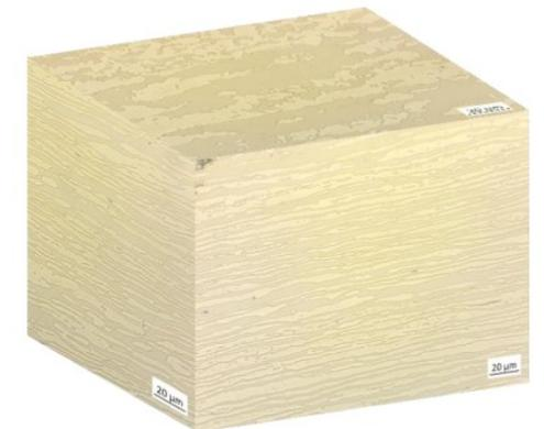
Figura 6: micrografia 3D del campione 61% deformazione
