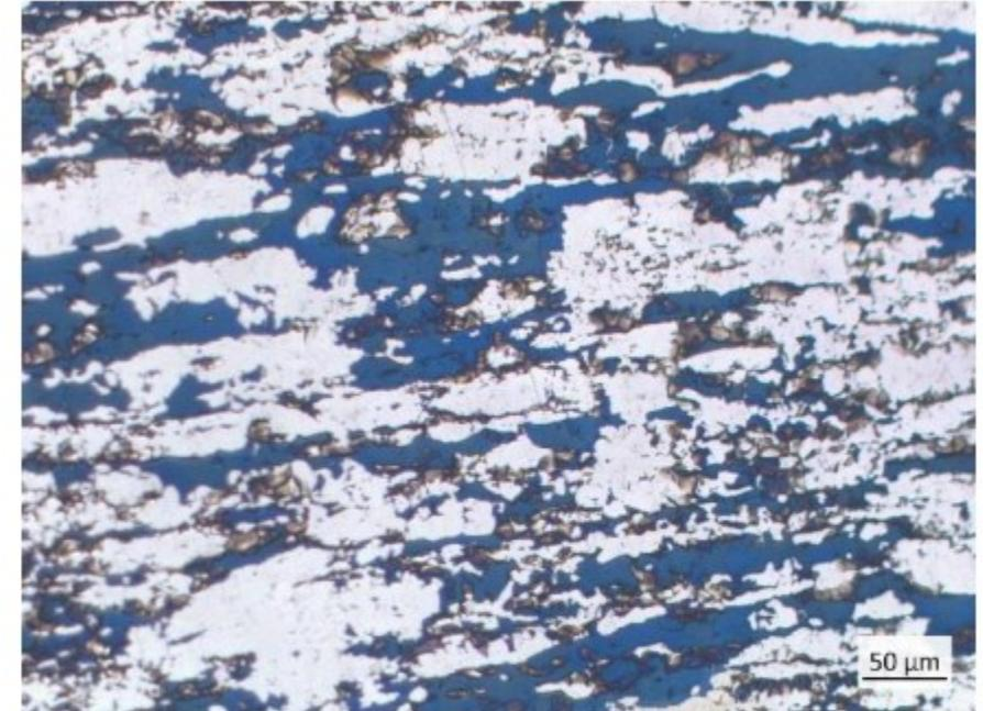
*Figura 1: microstruttura al microscopio ottico della superficie del campione di DSS deformato al 24% attaccata con la soluzione di Beraha*
