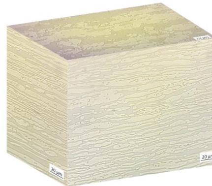
Figura 4: micrografia 3D del campione 24% deformazione
