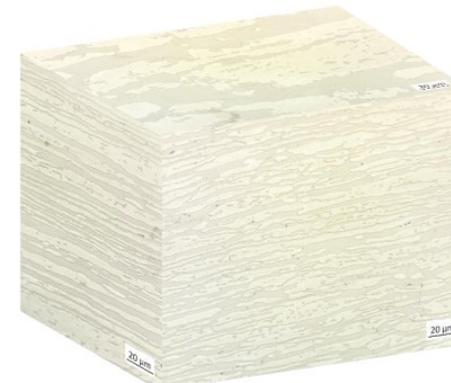
Figura 5: micrografia 3D del campione 45% deformazione
