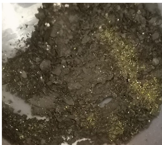
Figura 29 Particolare della polvere gialla del precursore visibile nel prodotto di colore grigiastro ottenuto dalla sintesi VLTVLC (205°C)
