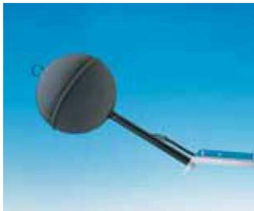
**Figura 5.6.** Globotermometro EST131
