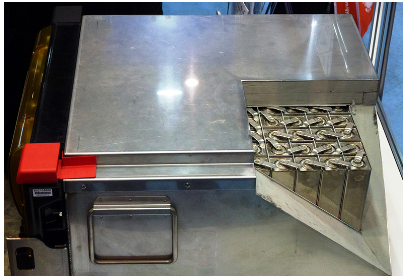
Figura 34: Contenitore con celle Zebra in serie [31].
