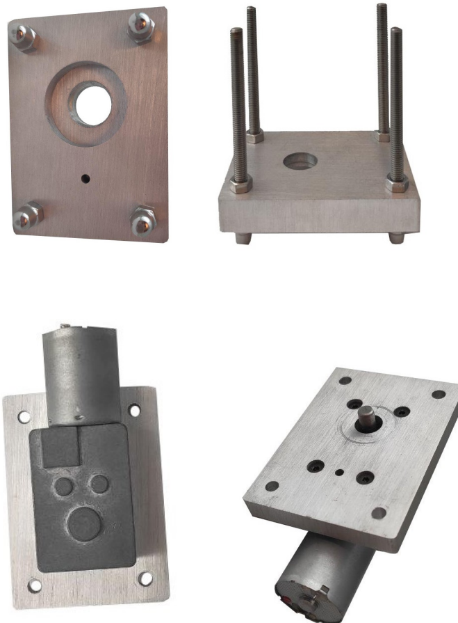
Figura 2.15: Sistema di accoppiamento motoriduttore-valvola
