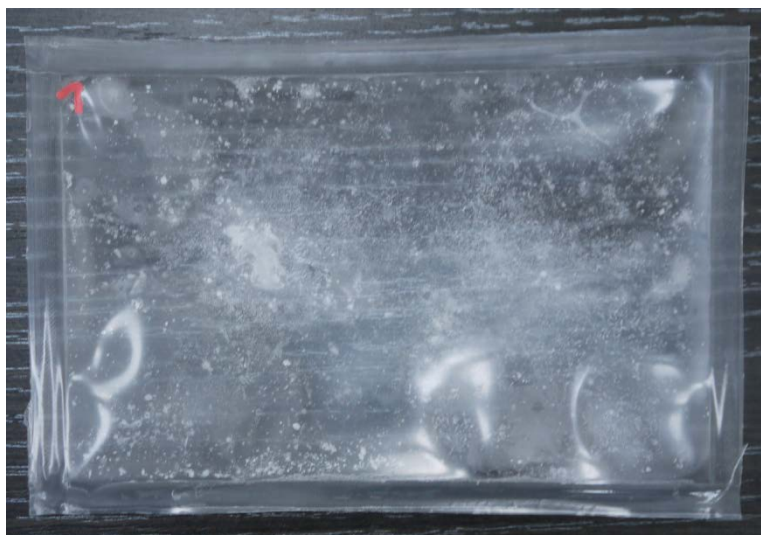
Figure 7.7. Provino dopo due settimane di immersione in AdBlue
