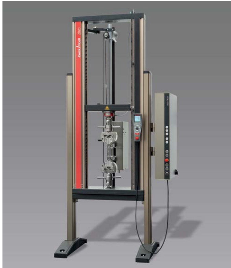
Figura5.3. immagine del dinametro usato per le prove a trazione
