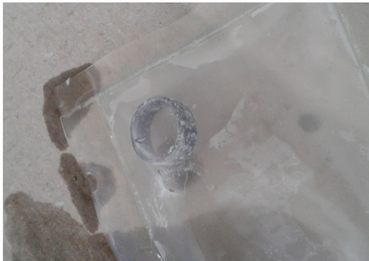
Figure 7.6. Provini dopo una settimana di immersione in AdBlue
