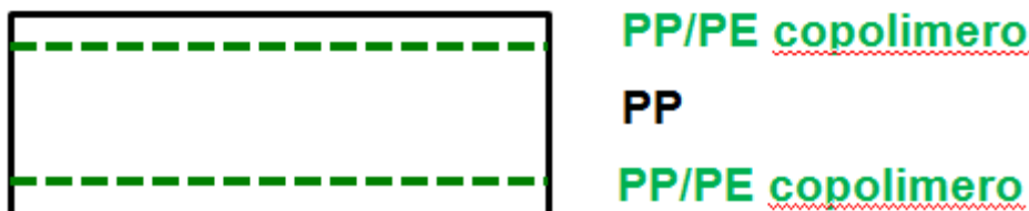
Figura 6.1: sezione schematica della struttura del film scelto per la protezione del riscaldatore
