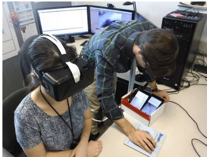
Fig. 14 Il soggetto (a sinistra) indossa il prototipo di auricolare VR per il tracciamento degli occhi disegnato da d'Antonio-Bertagnoli (a destra) mentre calibra le telecamere per il rilevamento degli occhi.
