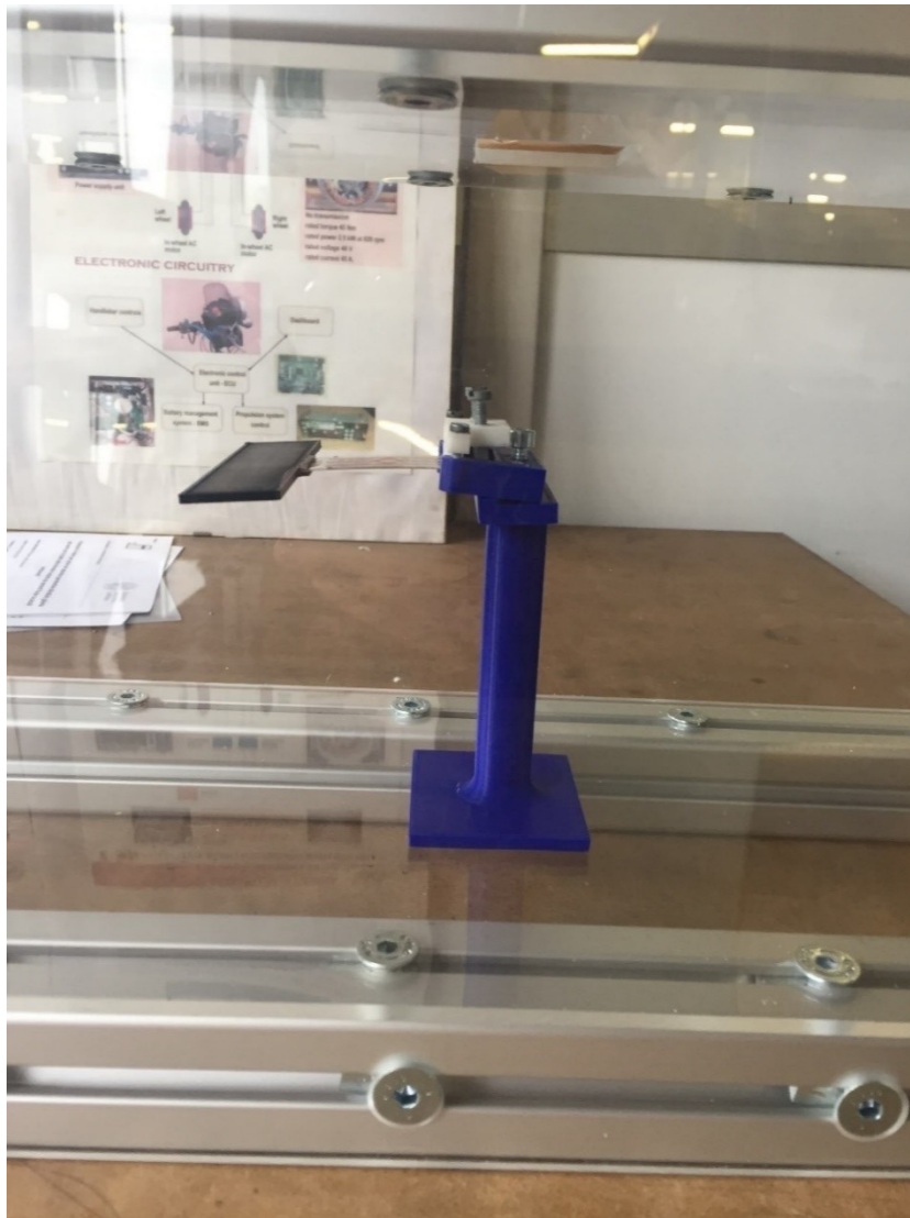
Foto 8: lastra piana in posizione in galleria (PPA1001)
