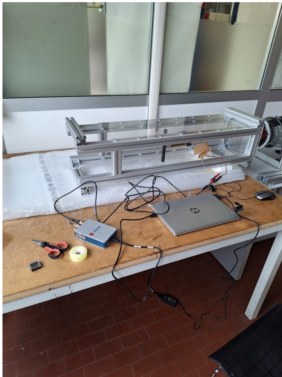
Foto 2: galleria del vento con harvester installato e apparecchiatura per la misura
