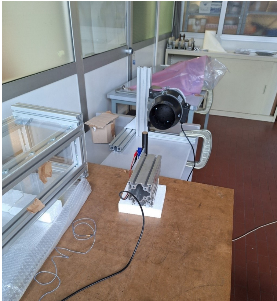
Foto 6: harvester predisposto per i test in corrente libera al di fuori della galleria del vento. Il gradiente di velocità misurato lungo la lunghezza del bluff body è dovuto in parte alla struttura del ventilatore stesso, in particolare dovuta all'orientamento delle pale statoriche. Il comportamento però simula un vento reale.
