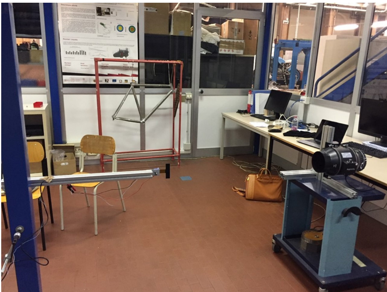
Foto 7: posizionamento dell'harvester a 1 m di distanza dal ventilatore, eliminando anche eventuali ostacoli che influenzino la circolazione dell'aria. Sia il bluff body che il successivo oscillatore a lastra piana sono stati testati in questa configurazione
