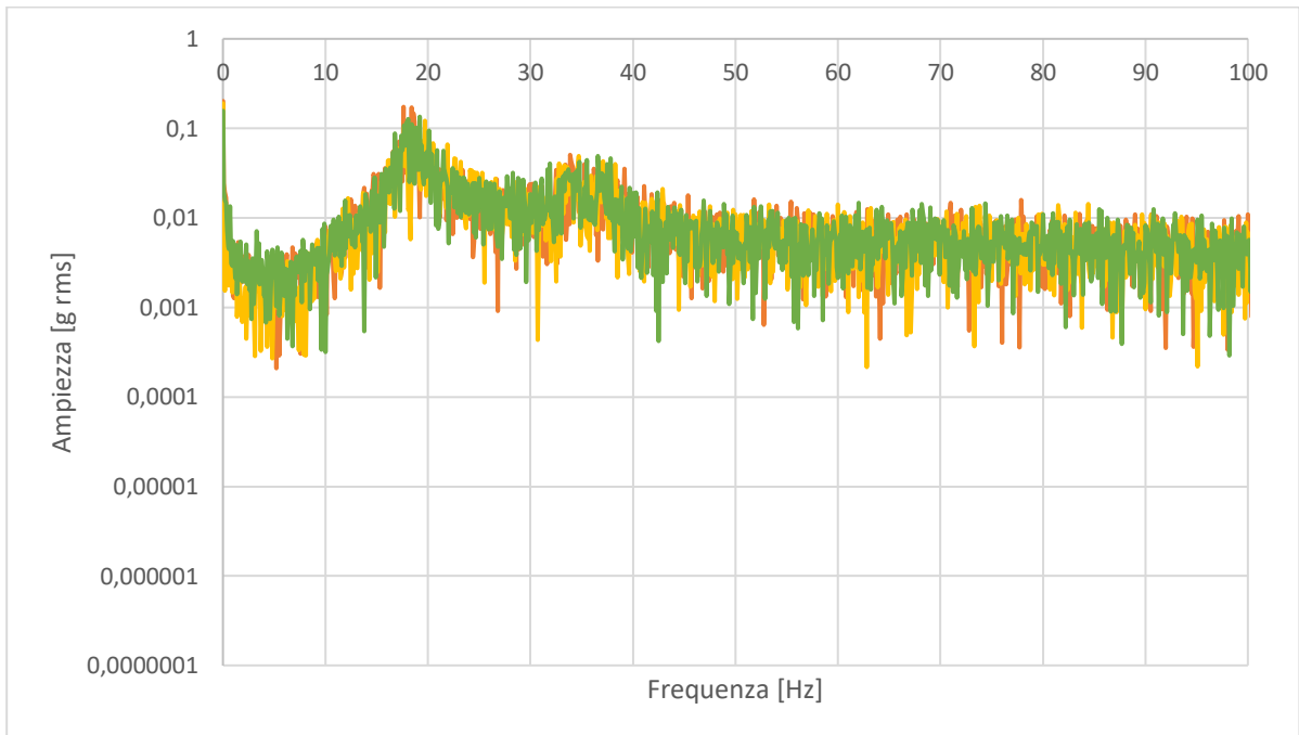
Figura 78: PSD accelerazione della lastra piana all'accensione del led
