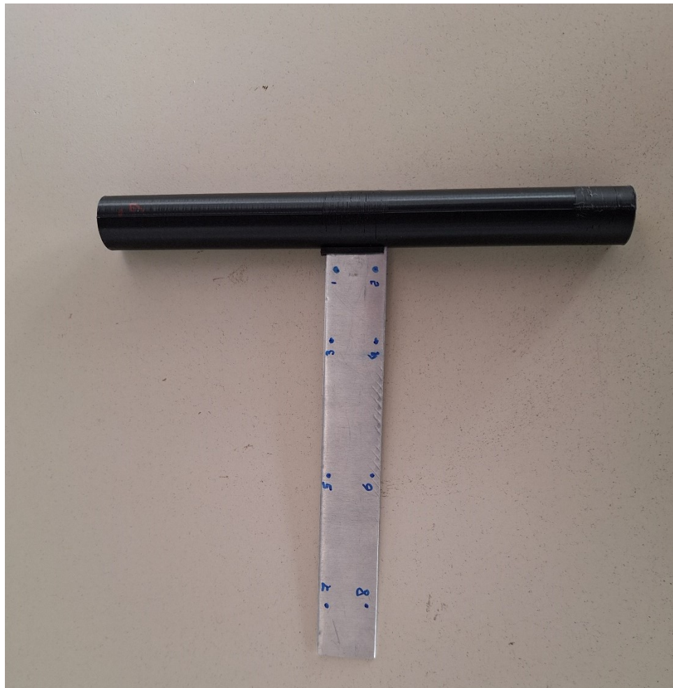
Foto 4: harvester senza patch e con relativi nodi per l'analisi modale; i nodi 7 e 8 sono in corrispondenza dell'incastro, i nodi 9 e 10 corrispondono invece al cilindro.
