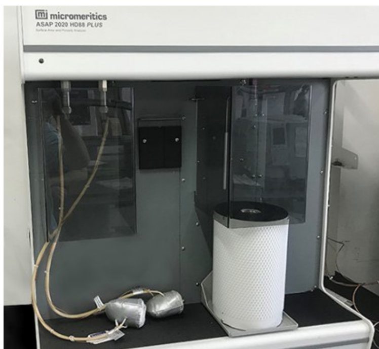
Figura 4.3: ASAP 2020. È visibile sulla sinistra il compartimento adibito al degasaggio, a destra il contenitore di azoto liquido per la misura di area superficiale.
