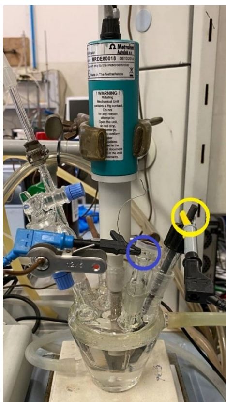
Figura 4.6: setup di cella sperimentale. Nel cerchio giallo è evidenziato il CE (grafite), nel cerchio blu il RE (RHE) e al centro è visibile il RRDE (WE).
