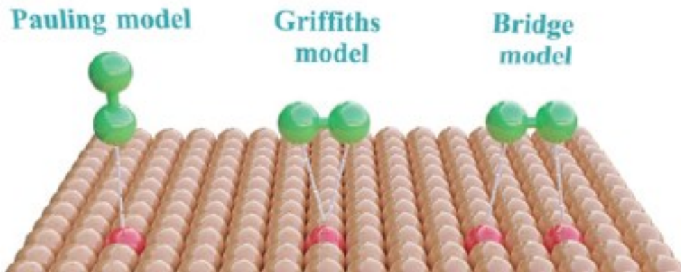
Figura 1.2: schematizzazione dei modelli di adsorbimento dell'ossigeno su di una superficie metallica [7]
