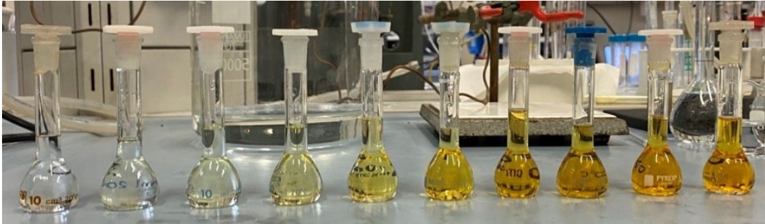
Figura 4.10: matracci contenenti soluzioni a concentrazione crescente di H_2O_2 titolata con TiOSO_4
