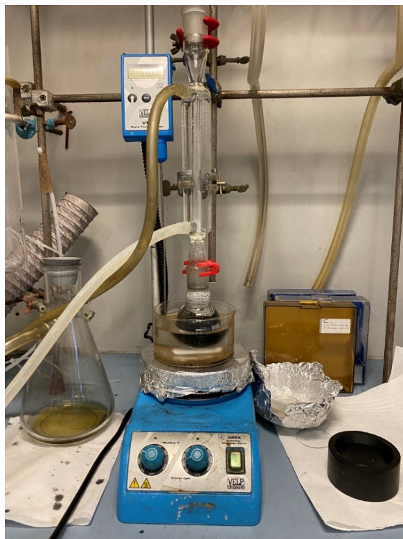
Figura 4.2: impostazione della sintesi di grafting per temperature di 40°C e 60°C.
