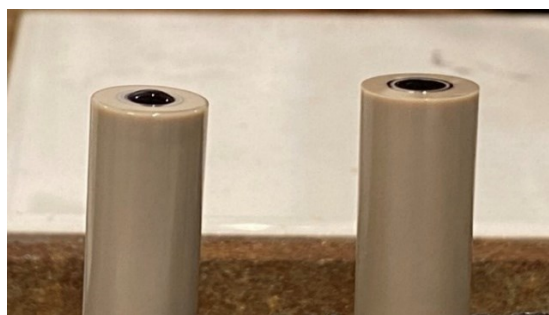
Figura 4.7: drop-casting su elettrodi
