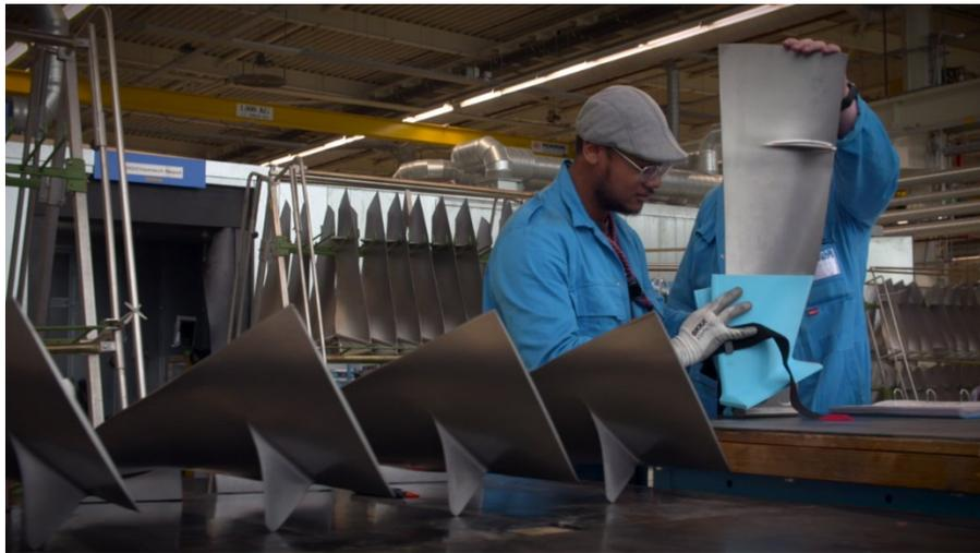
Figura 11. Rivestimento protettivo per una turbina stampato in 3D da KLM E&M. Fonte: [news.klm.com](https://news.klm.com)<sup>38</sup>
