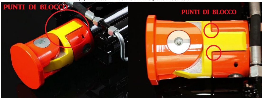
(d) Dimostrazione limite di movimento del timone
