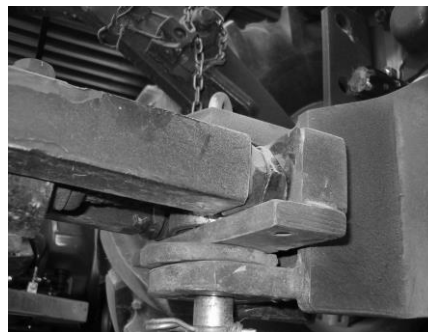
fig.5.4 Timone con piastre usurate per gli eccessivi sforzi in gioco
