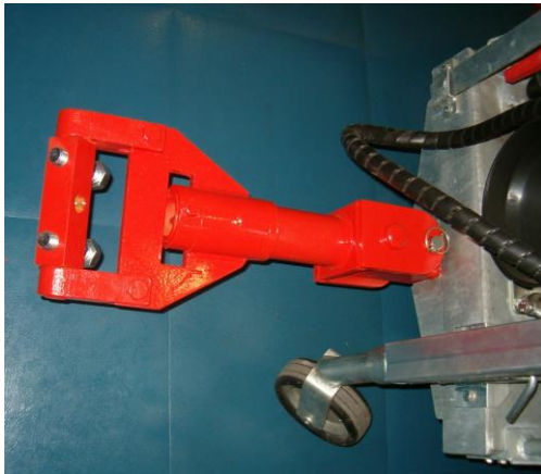
fig. 5.1: Sistema di traino non omologato stradale - per clienti che usano il mezzo solo in campagna
