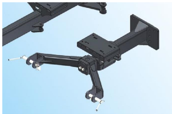
Fig.5.2: Timone di traino a sollevamento non omologato stradale
