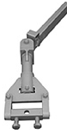
fig. 5.1: Sistema di traino non omologato stradale - per clienti che usano il mezzo solo in campagna
