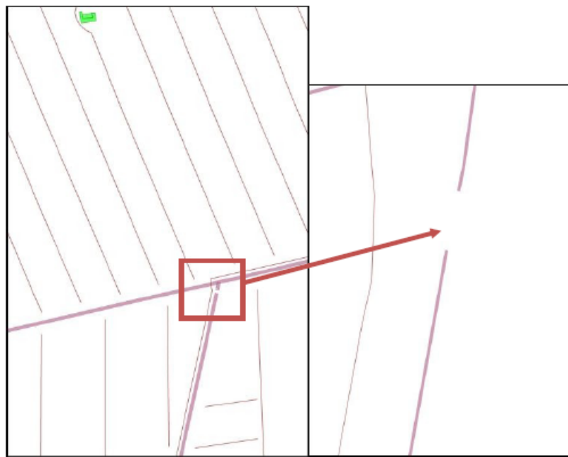
Figura 13: Esempio d'interruzione in una strada
