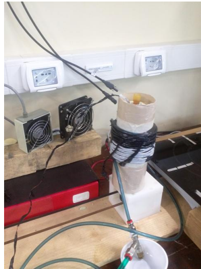
Figura 5.15: versione finale dell'induttore con raffreddamento liquido con spessore dell'isolamento visibilmente aumentato
