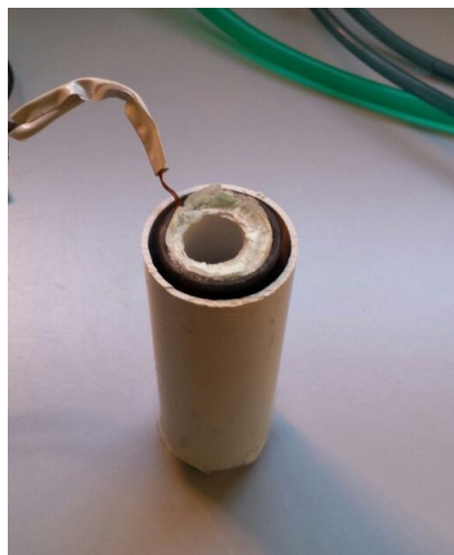
Figura 5.8: primo induttore con spessore di isolamento aumentato
