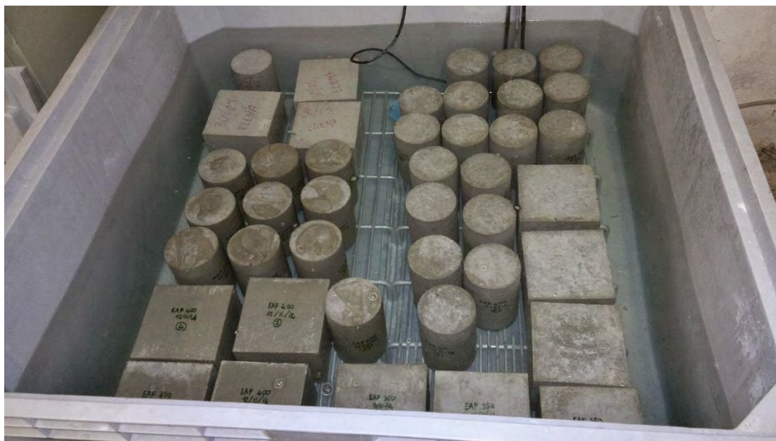
Figura 4.5 Provini cubici e cilindrici durante la stagionatura in vasca a 20°C.
