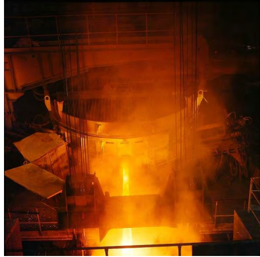
Figura 2.1 Crogiolo durante la spillatura dell'acciaio
