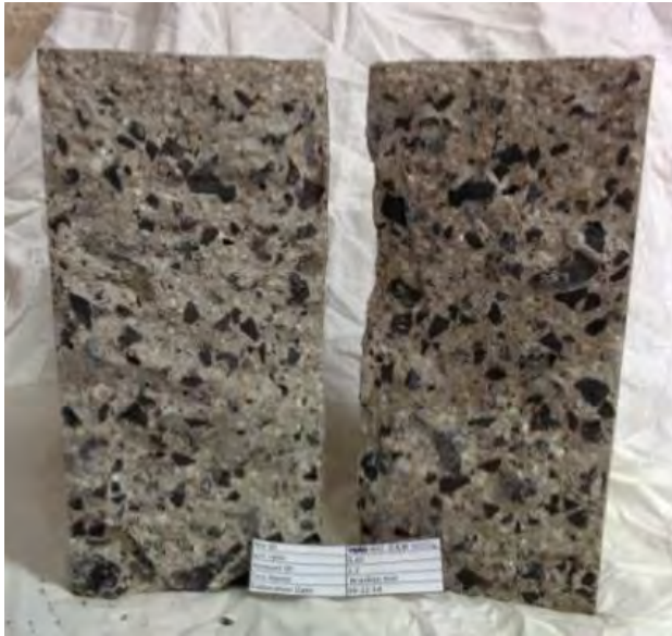
Figura 4.176 Calcestruzzo con EAF dopo prova brasiliana.
