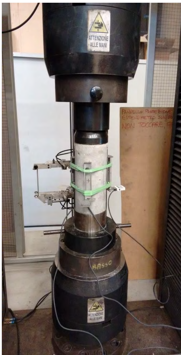
Figura 4.23 Provino pronto per l'esecuzione della prova, si possono notare i 3 estensimetri applicati.
