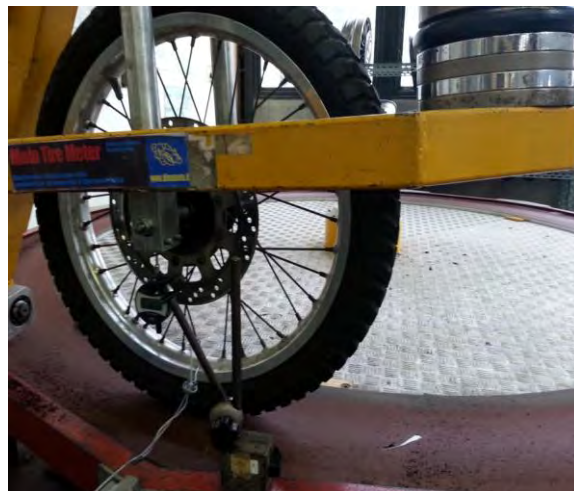
Figura 3.30 Prova di rigidità radiale per lo pneumatico anteriore
