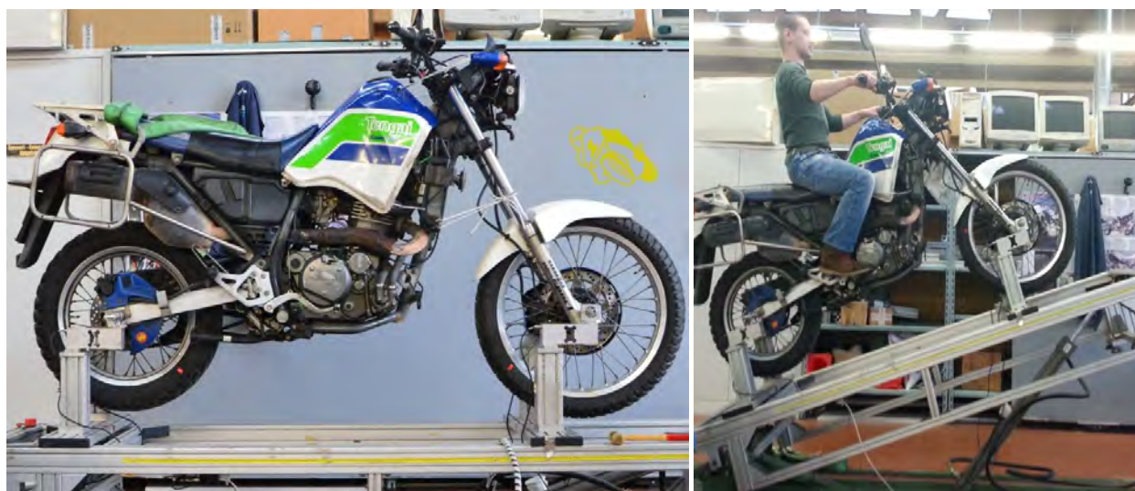
Figura 5.2 Esecuzione delle misure sperimentali per la determinazione del baricentro in : empty tank a sinistra e full tank+rider a destra
