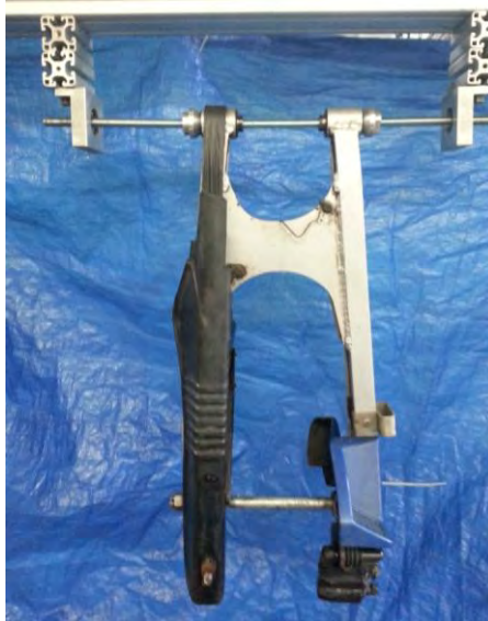
Figura 5.17 Misura del momento d' inerzia I_y dello swingarm
