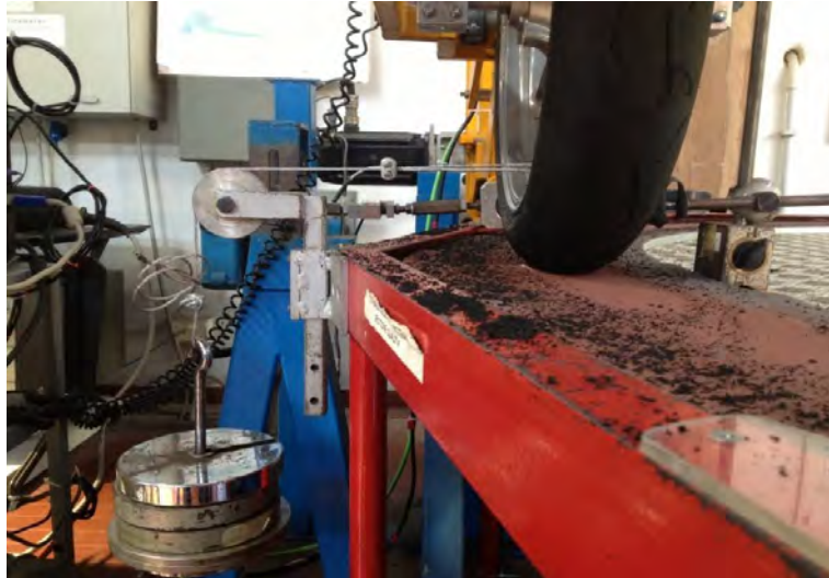
Figura 3.31 Prova di rigidità laterale per lo pneumatico posteriore
