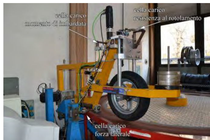
Figura 3.7 Celle di carico per la misura di forze e momenti
