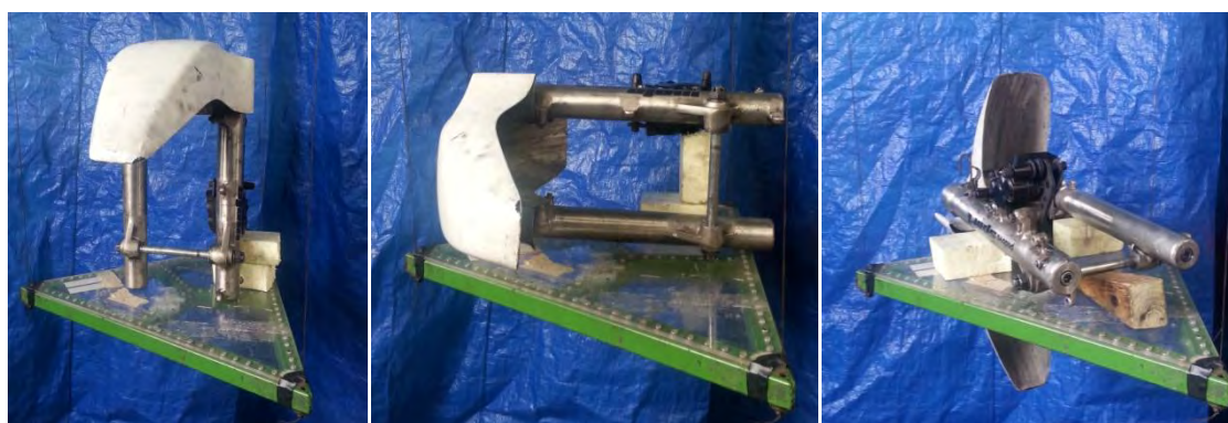
Figura 5.28 Da sinistra misure per determinare: I_z , I_y , I_x
