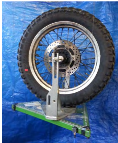
Figura 5.24 Misura del momento d' inerzia diametrale della ruota posteriore
