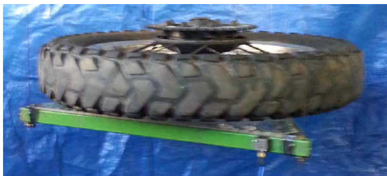
Figura 5.25 Misura del momento d' inerzia polare della ruota
