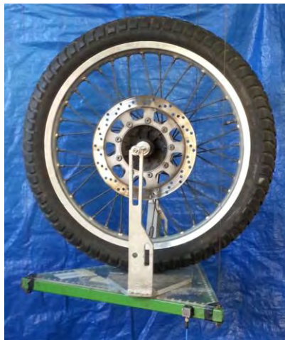
Figura 5.22 Misura del momento d'inerzia diametrale della ruota anteriore
