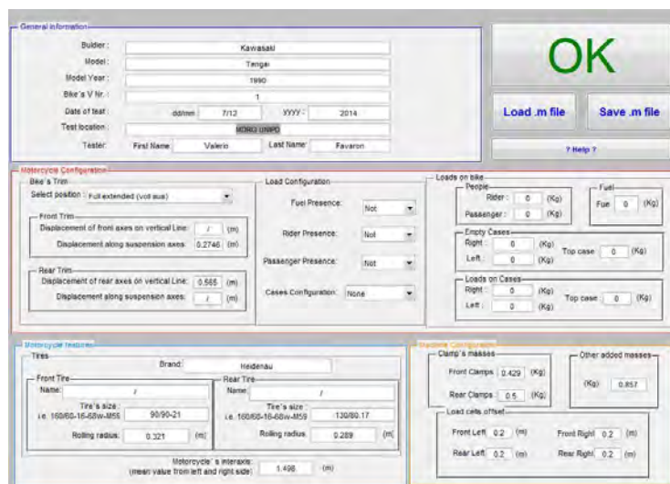
Figura 4.2 Interfaccia del software per l'elaborazione dei risultati provenienti dall'acquisizione in LabView. Nel caso in esame in condizioni di empty tank.
