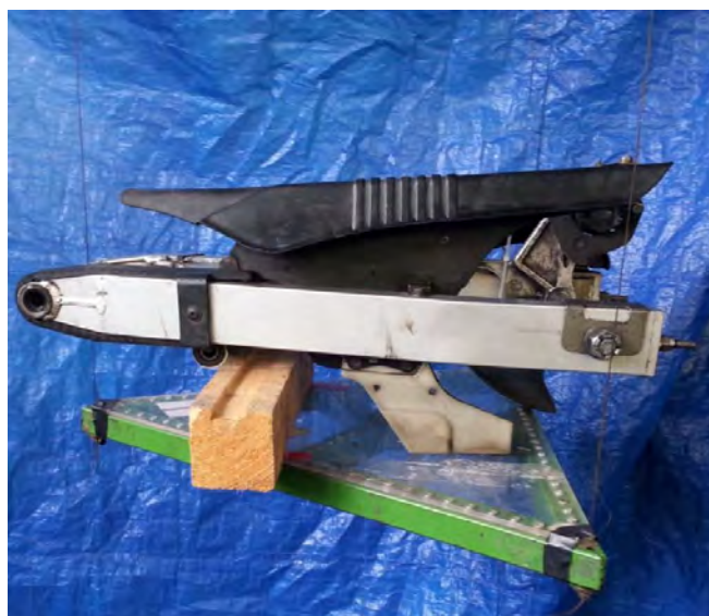
Figura 5.19 Misura del momento d' inerzia I_z dello swingarm
