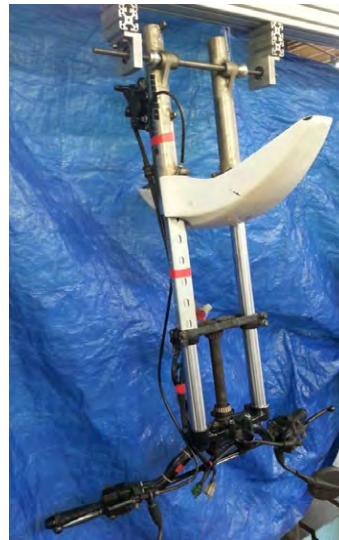
Figura 4.9 A sinistra modello utilizzato per la determinazione del momento d' inerzia. A sinistra, esempio di esecuzione di una prova per l' avantreno
