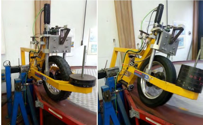
Figura 3.9 A sinistra test al variare dell' angolo di slip per lo pneumatico posteriore, pressione 2.5 bar, carico 1500 N. A destra test al variare dell' angolo di rollio per lo pneumatico posteriore, pressione 2.5 bar, carico 2000N
