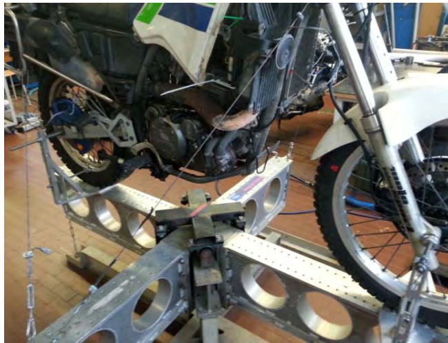
Figura 5.6 Veicolo montato sulla pedana per la misura del tensore d' inerzia
