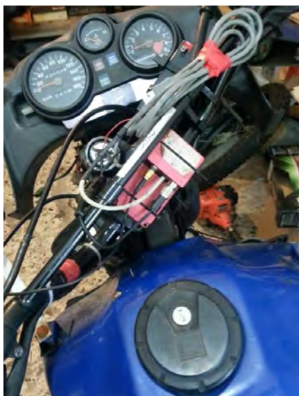
Figura 2.2 sensori montati sull' asse di sterzo
