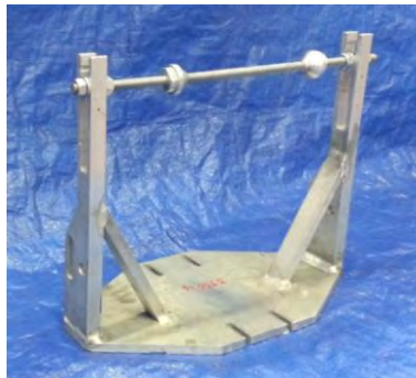
Figura 5.21 Supporto utilizzato per la misura del momento d'inerzia diametrale
