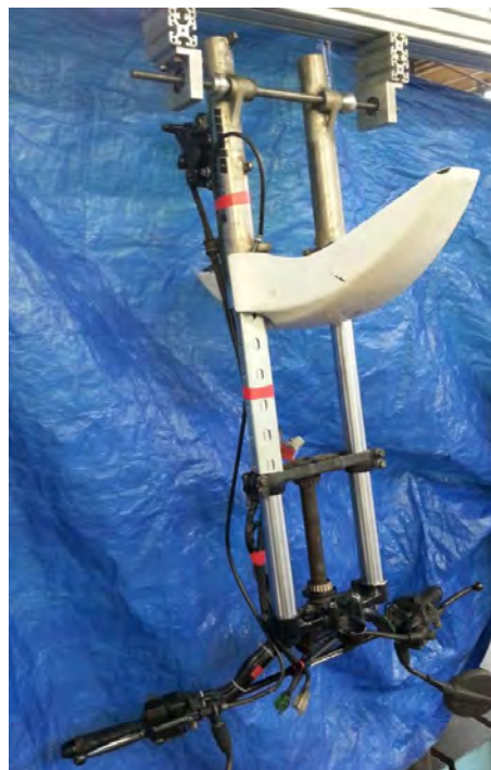
Figura 5.12 Misura del momento d'inerzia I_y dell'avantreno
