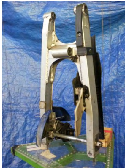
Figura 5.18 Misura del momento d' inerzia I_x dello swingarm
