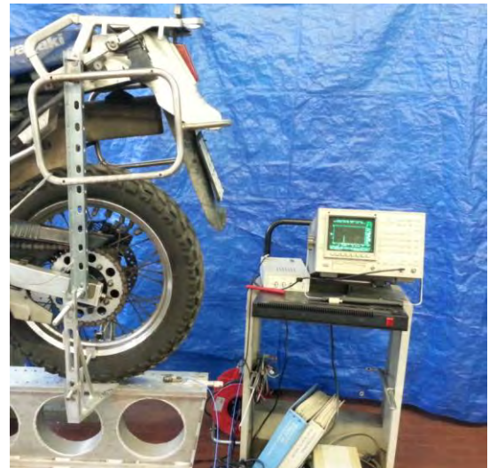
Figura 5.7 Misurazione della frequenza di oscillazione del veicolo a beccheggio
