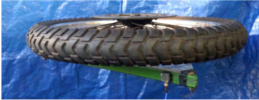
Figura 5.23 Misura del momento d' inerzia polare della ruota anteriore
