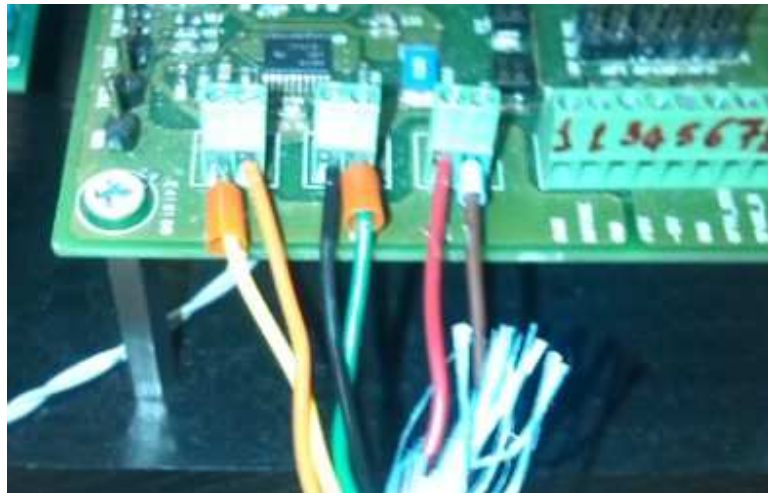
Figura 4.4 Cablaggio scheda E3
