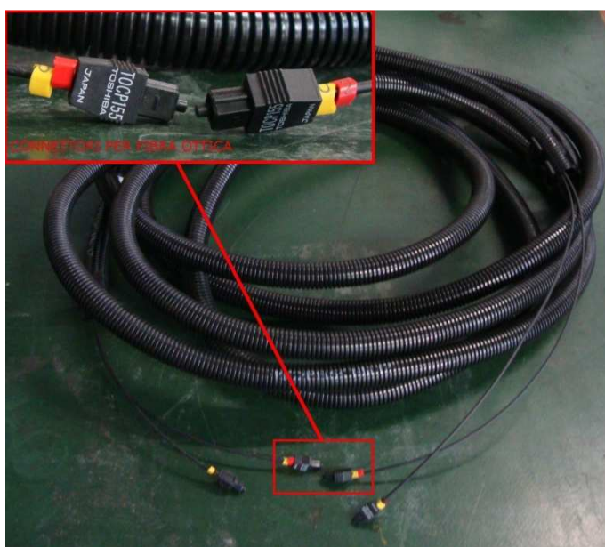
Fig. 12.5 Cavi in fibra ottica per l'interconnessione tra generatore e matchbox
