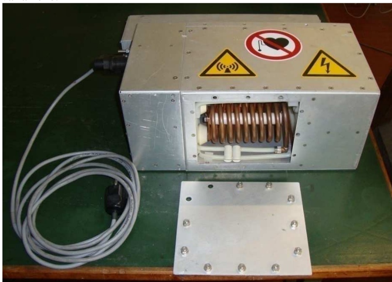
Fig. 12.6 Rete di adattamento o Matchbox
