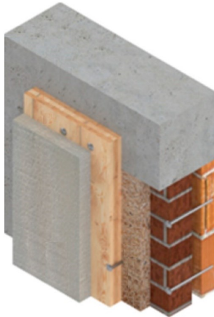
Rinforzo con pannellatura CLT (mdpi, 2020)
