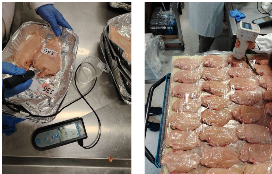
Figura 12. A sinistra rilevazione del pH, a destra misurazione del colore con colorimetro.
