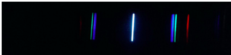
Figura 42.: Spettro dalla lampada al Cadmio ottenuta tramite lo spettroscopio costruito a mano.
