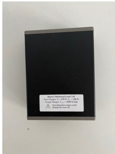
Figura 2.3.5. A sinistra la cella di carico triassiale utilizzata e a destra il fondo scala da 70 N
