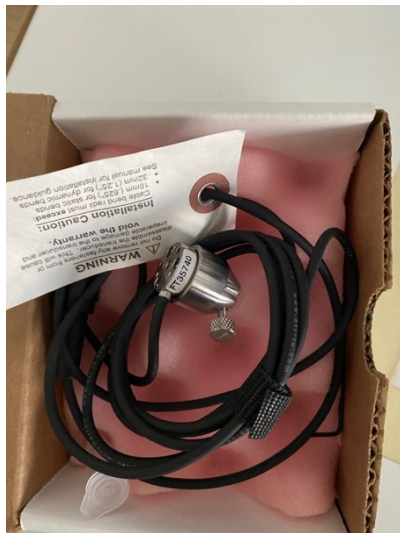
Figura 2.3.5. A sinistra la cella di carico triassiale utilizzata e a destra il fondo scala da 70 N
