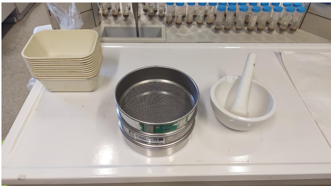
*Fig. 4: Pestello e setacci utilizzati per selezionare i granuli per l'analisi*
