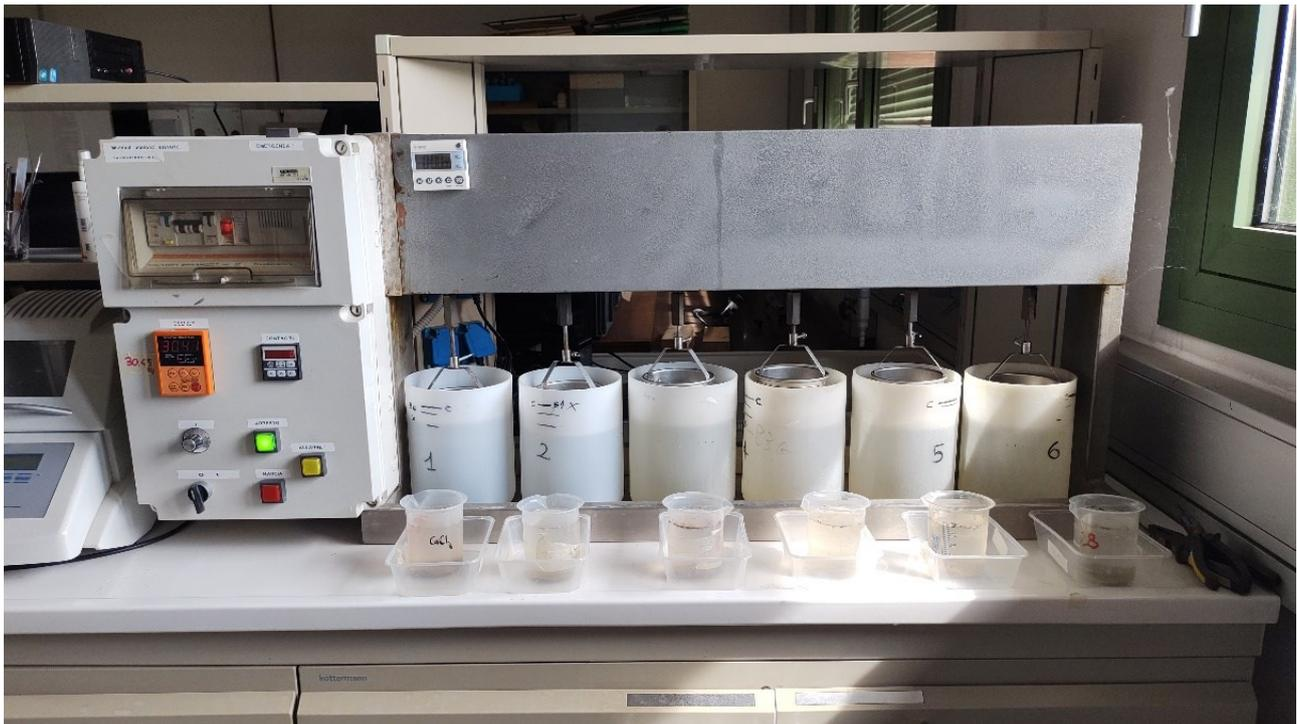
*Fig. 5: Dispositivo di Tiulin utilizzato nell'analisi*
