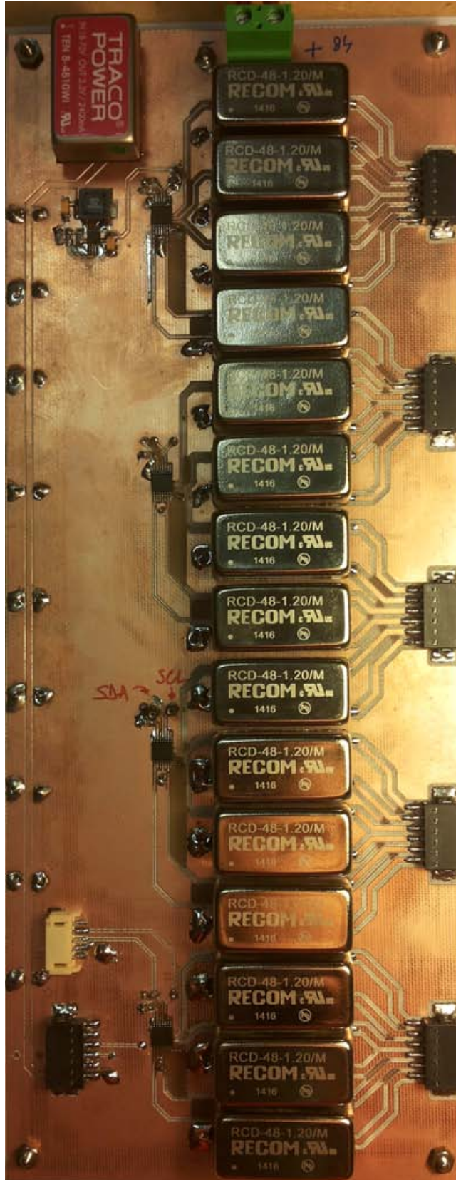
Figura 46: Scheda di potenza realizzata e con i componenti montati.
