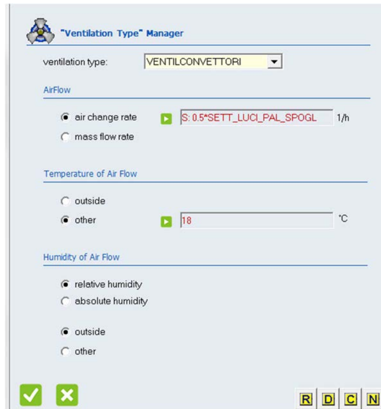
Figura 3.8: Interfaccia grafica per l'impostazione dei parametri del sistema di ventilazione
