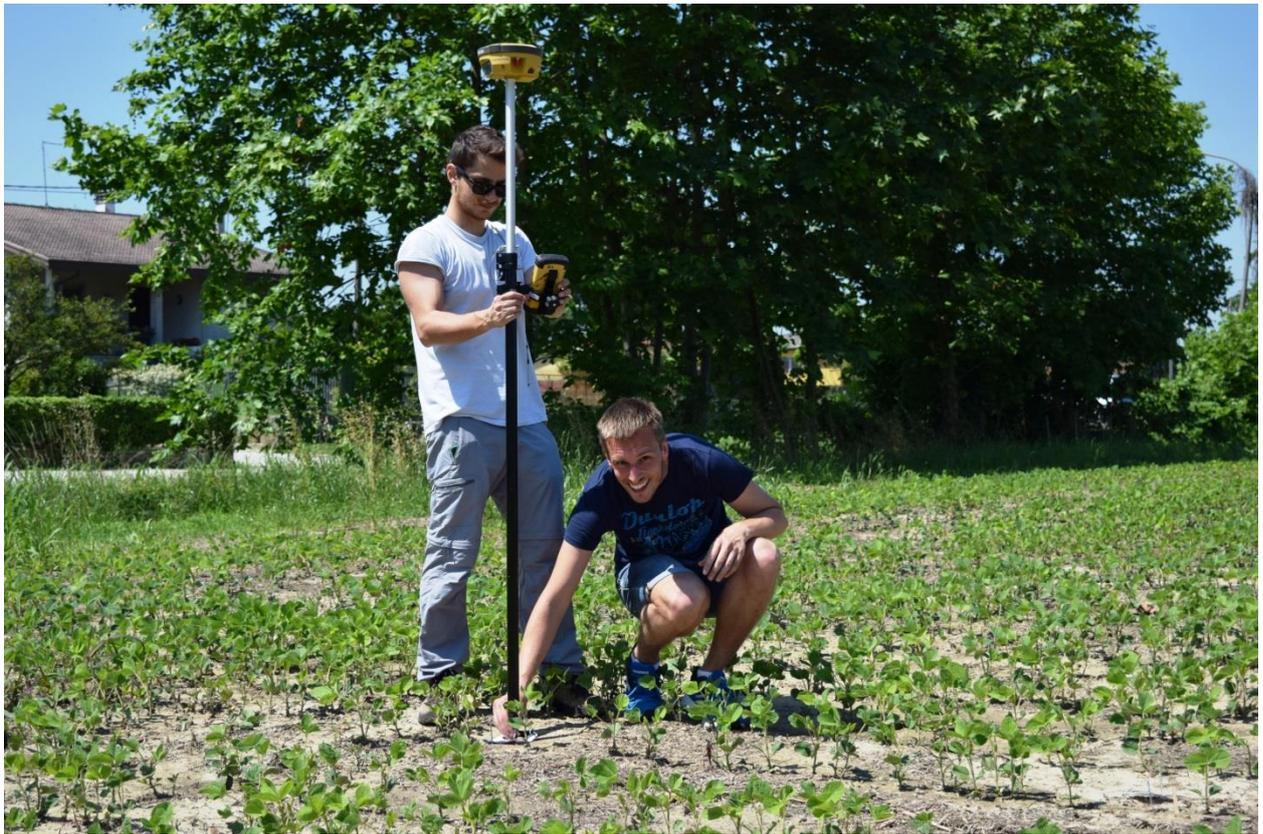
Figura 3.3 Il ricevitore GNSS Topcon Hiper V utilizzato per la georeferenziazione dei targets
