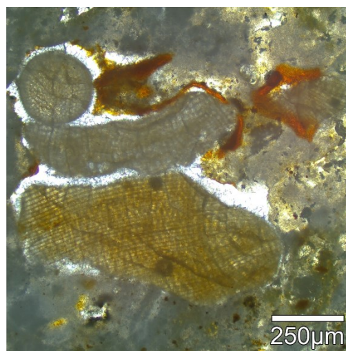
Figura 5.9: Micrografia di dettaglio in microscopia ottica a luce polarizzata, in luce trasmessa (LT) a nicol paralleli (PN) di un relitto di calcinazione. Si nota la tessitura delle alghe rosse fossili presenti all'interno della calcarenite fossilifera.
