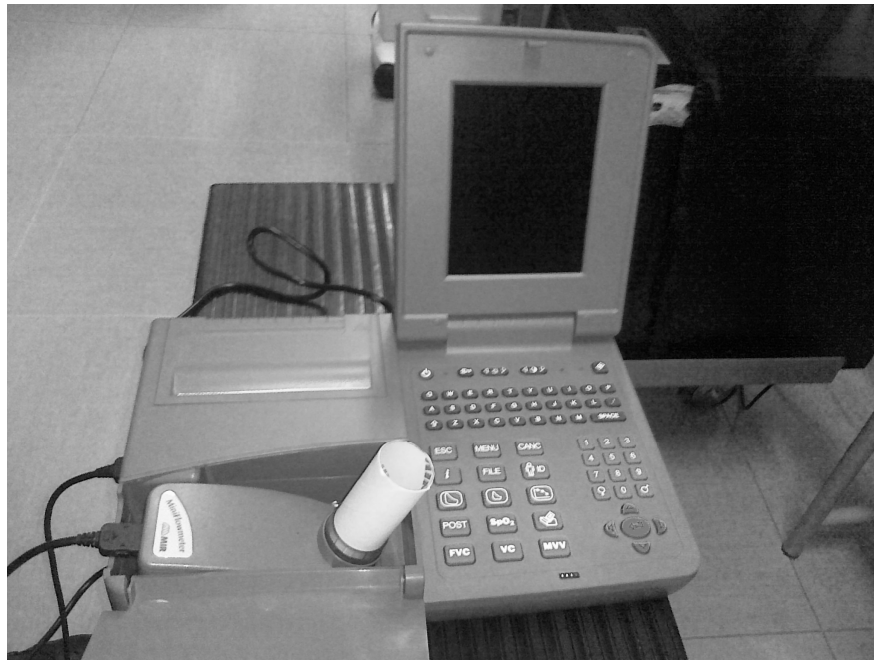
Figura 2.2, lo Spirolab III sottoposto a prove di accettazione e collaudo
