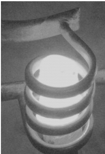
Figura 1-5: rilevazione della permeabilità magnetica.
