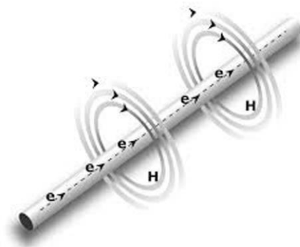
Figura 1-2: campo magnetico attorno ad un filo percorso da corrente continua
