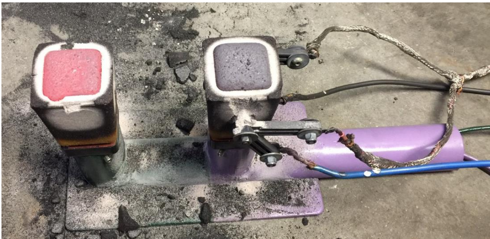
Figura 3-3: Foto delle chill cup durante la solidificazione. Confronto tra ghisa senza elettrodi e con elettrodi
