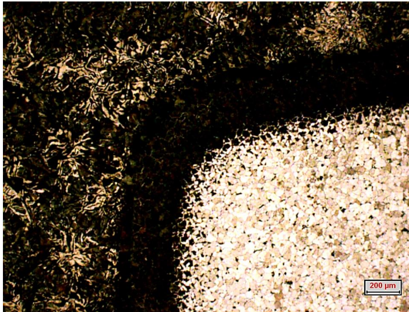
Figura 3-2: microstruttura elettrodo con il primo metodo
