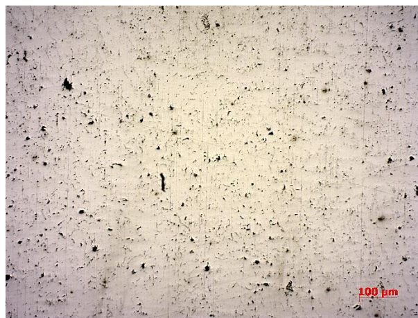
Figura 2-8: microstrutture delle ghise utilizzate nella colata. Rispettivamente dall'alto verso il basso: G15, G25, G35
