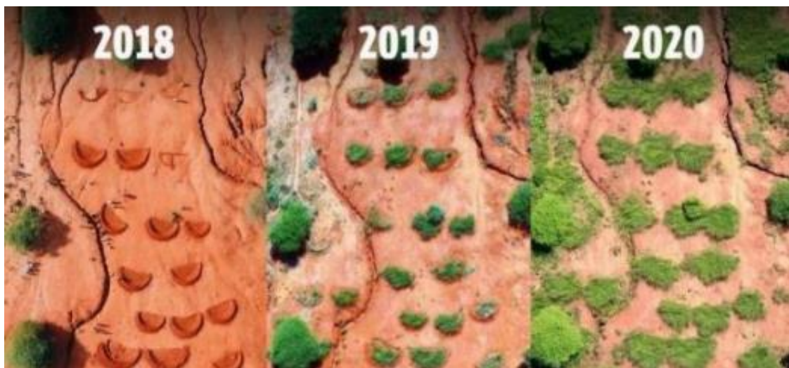
Figura 5.7 – Panoramica dei water bund e graduale ripristino dell’ecosistema nel triennio 2018-2020 (foto da : www.edition.cnn.com )
