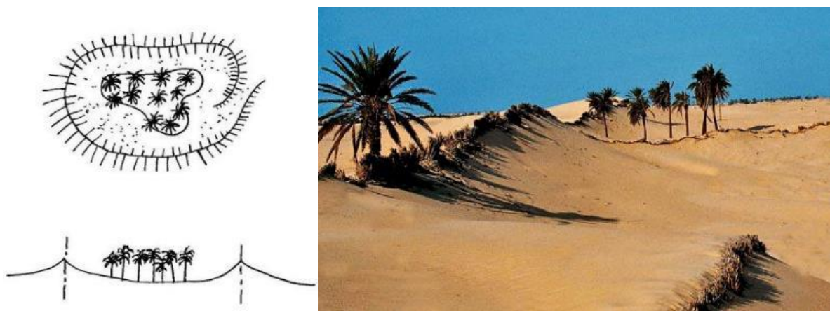
Figura 3.32 – Schema grafico (a sinistra) delle dune artificiali e barriere vegetali (a destra) (foto da www.pangea-project.org )
