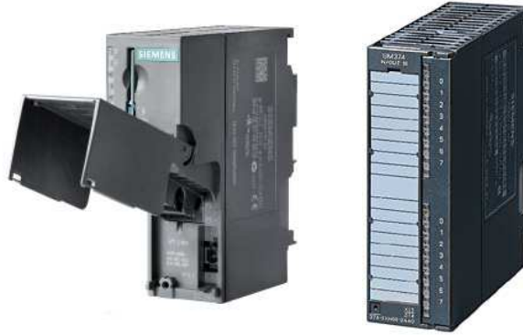
Figura 3.3: Foto del modulo ET200M complessivo di unità modulare I/O SM374.
