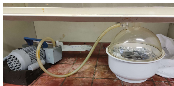
Figura 2.15: Silanizzazione del master con pompa a vuoto ed essiccatore.
