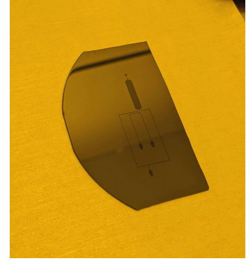
Figura 2.14: Master correttamente sviluppato e asciugato.
