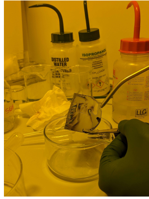
Figura 2.13: Asciugatura del master con aria compressa.
