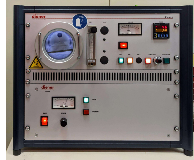
Figura 2.10: Plasma cleaner in funzionamento. La bombola di ossigeno è nascosta al di sotto del ripiano d'appoggio.
