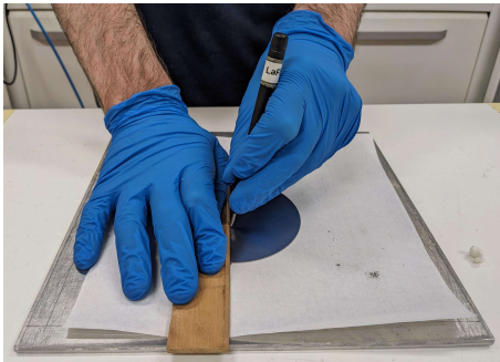
Figura 2.9: Taglio del wafer in Silicio con punta diamantata. L'incisione va effettuata sulla faccia non lappata.
