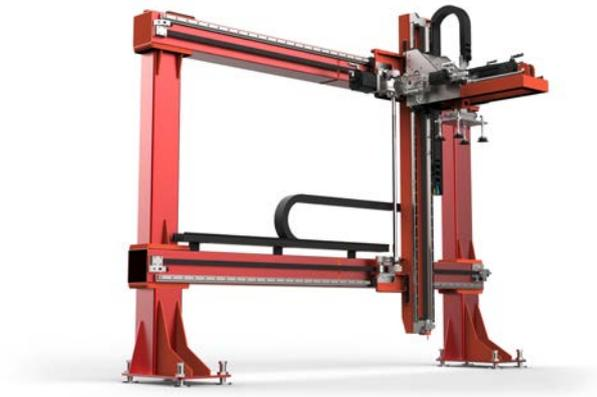
Figura 1.2: Esempio di robot cartesiano a 3 assi. Fonte: [www.robotcartesiani.com](http://www.robotcartesiani.com)
