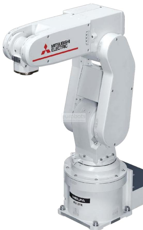
Figura 1.6: Esempio di robot antropomorfo a 6 assi. Fonte: Mitsubishi
