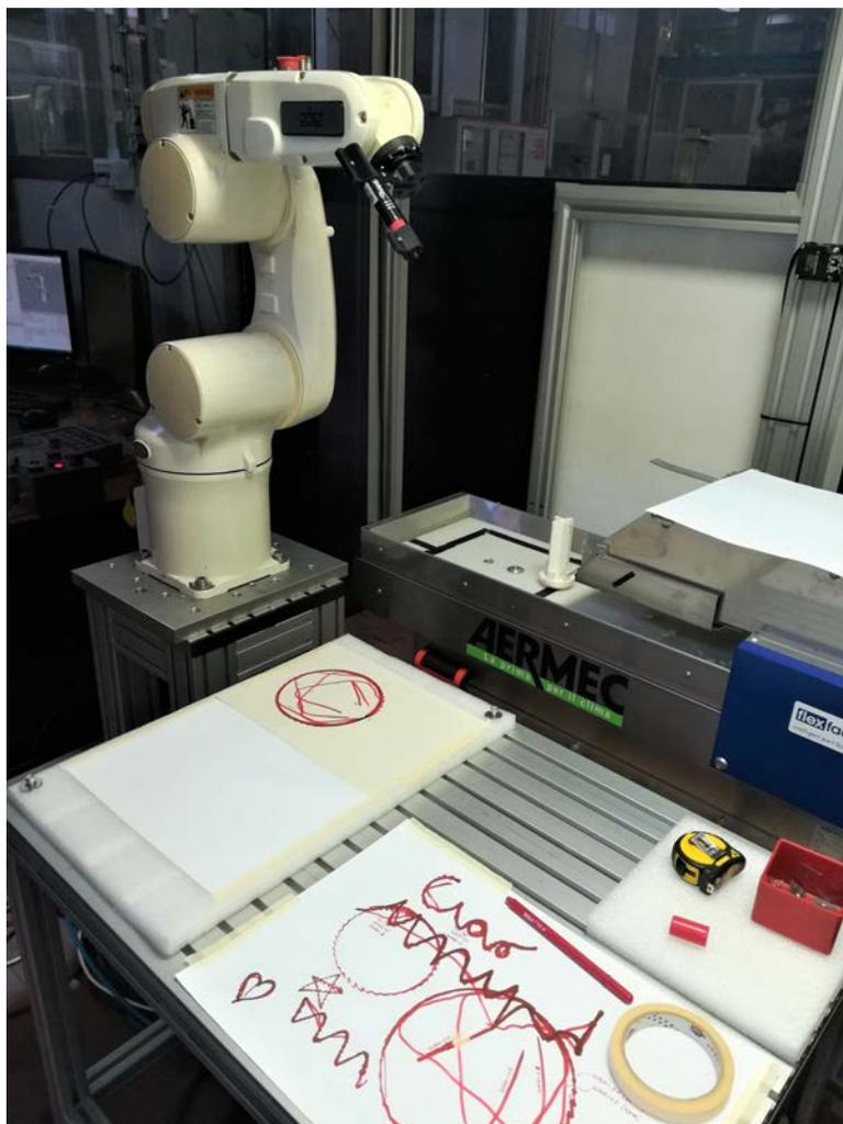
Figura 5.1: Cella robotizzata con robot Adept Viper s650 e piano di scrittura utilizzati per la fase sperimentale di questa tesi
