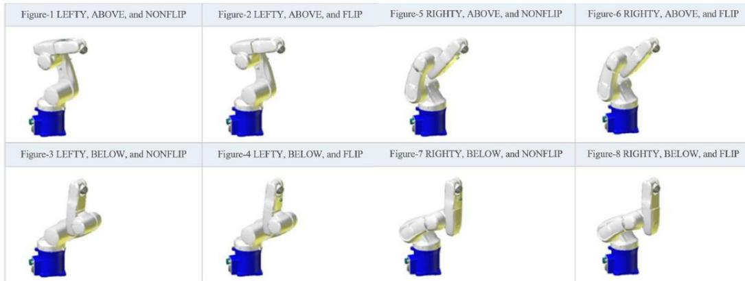
Figura 2.6: Le 8 possibili configurazioni per un robot antropomorfo a polso sferico
