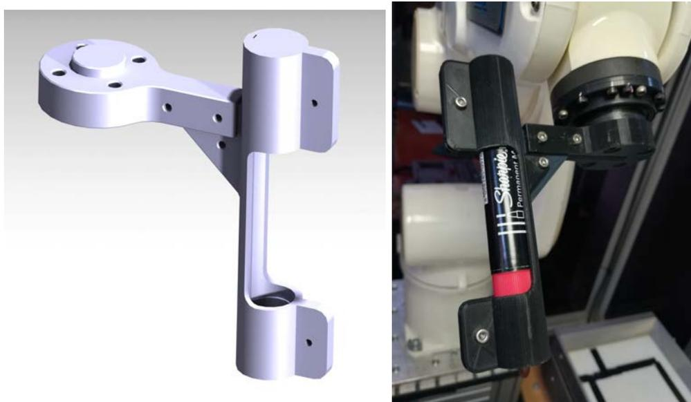
Figura 4.2: Utensile a sbalzo utilizzato nelle prove sperimentali: modello CAD 3D realizzato con CATIA V5 (a sinistra) e prototipo stampato con tecnologia FDM (a destra)
