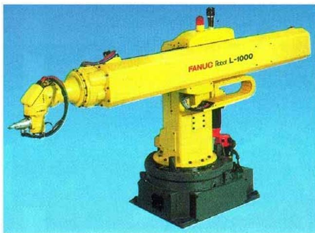
Figura 1.4: Esempio di robot sferico. Fonte: Fanuc
