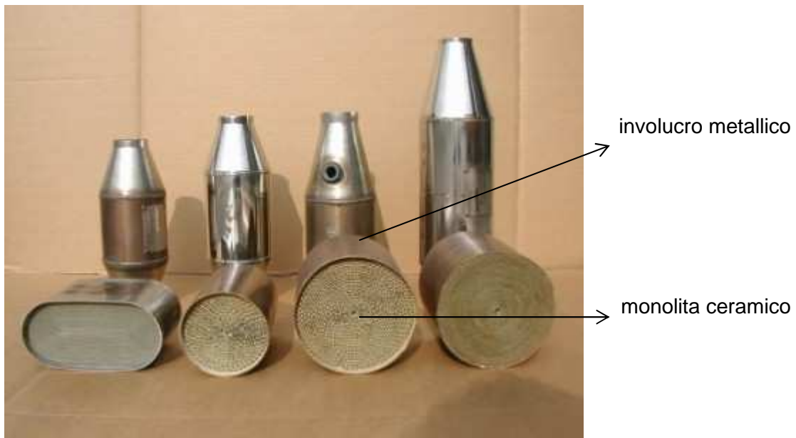
Figura 4: convertitori catalitici in materiale ceramico aventi struttura a nido d'ape.
