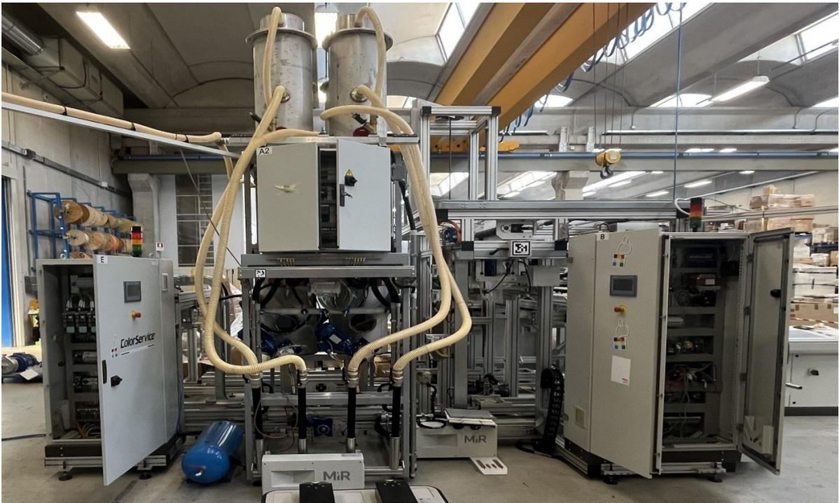
[Figura 10: foto della “facciata” laterale dell’impianto dove in particolare vengono mostrate la stazione di insacco sulla parte destra e la prima stazione di dosaggio al centro costituita da un modulo di 4 silos.]
