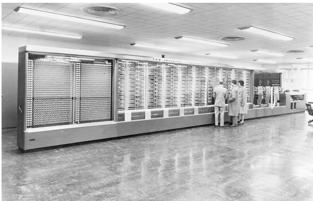
Fig. 2.1 – 1944: il computer Harvard Mark I. Riporto la traduzione di un estratto dall’Enciclopedia britannica: «Questo calcolatore elettromeccanico, lungo oltre 15 metri e composto di oltre 750 000 pezzi, venne usato per condurre calcoli balistici durante la Seconda Guerra Mondiale». Fonte: Freiburger. P.A., Harvard Mark I , Enciclopedia britannica
