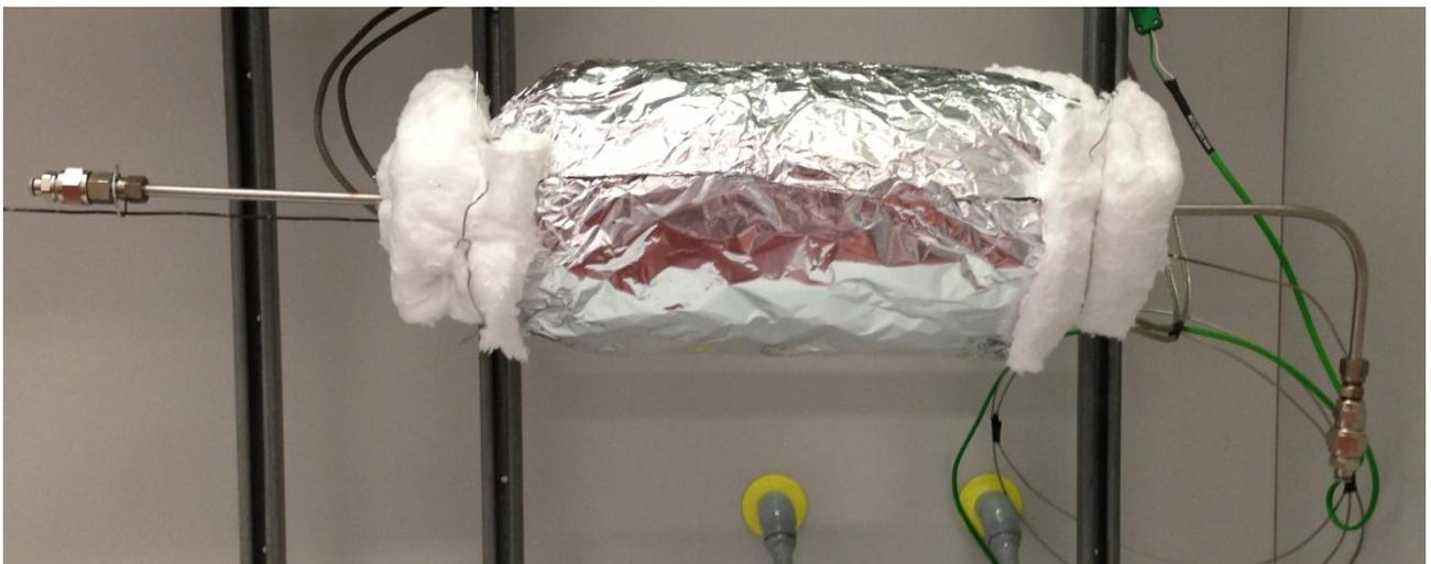
**Figura 4.16:** *Reattore coibentato con lana di roccia.*
