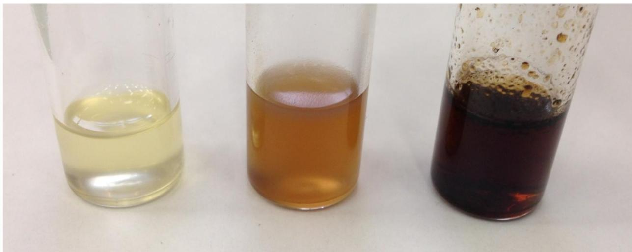
**Figura 7.25:** Condense diluite in diclorometano. Da sinistra a destra: condense del polipropilene, condense del mix e condense del caffè.
