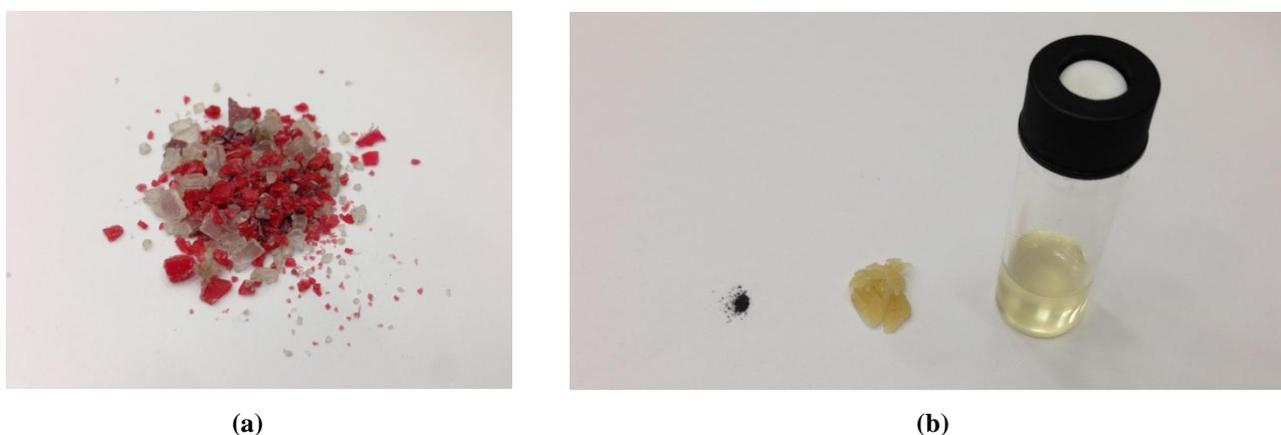
**Figura 7.2:** (a) polipropilene della cialda caricato nel reattore; (b), da sinistra a destra, residuo carbonioso, condense del primo stadio di condensazione e condense del secondo stadio di condensazione diluite in diclorometano.
