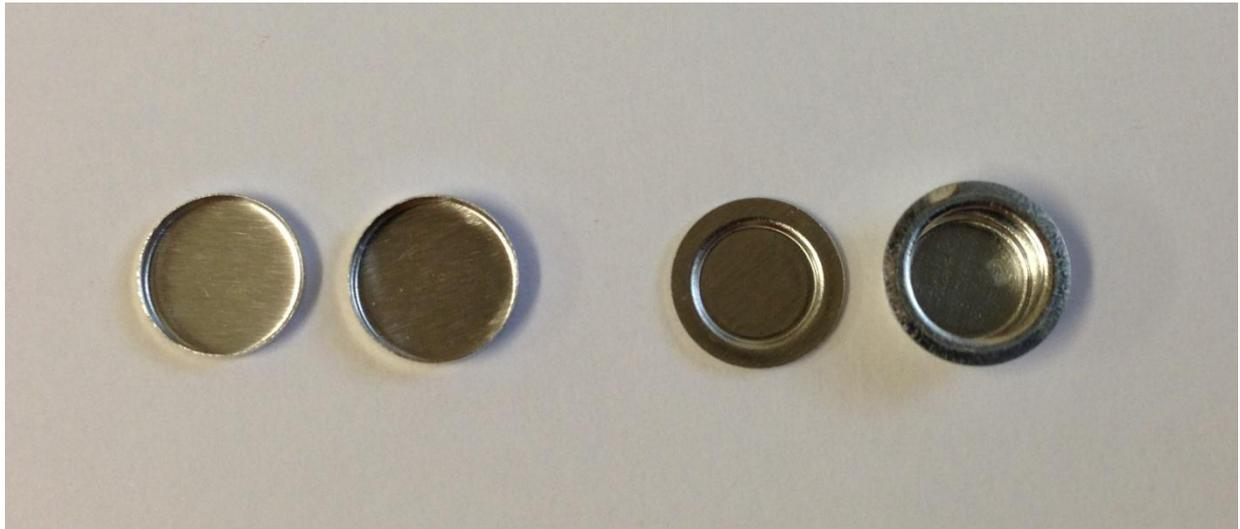
**Figura 5.5:** Capsule utilizzate: a sinistra coperchio e fondo della capsula normale a destra coperchio e fondo della capsula ermetica.
