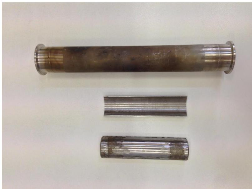
**Figura 4.13:** Dall'alto: forno, crogiolo e occlusore che verrà montato sopra il crogiolo in acciaio inox.
