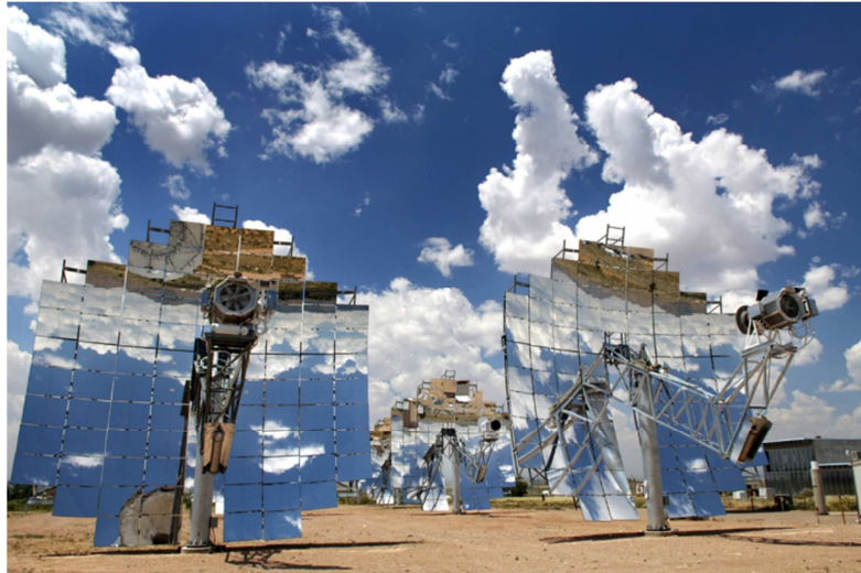
Fig. 1.4: applicazione nel solare termodinamico del motore Stirling.
