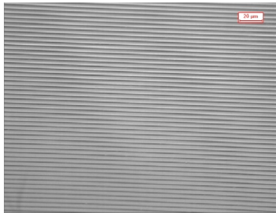
Fig. 4.24 Pattern trasferito sulla superficie di un campione di G1T6.7 + TMTE, sottoposto a imprinting con forza applicata di 6 KN e temperatura di 100° C. (500x)
