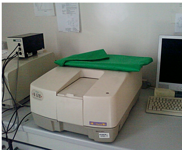
Fig.4.36C Spettrofotometro Jasco V-670 utilizzato nel campo del visibile e dell'ultravioletto
