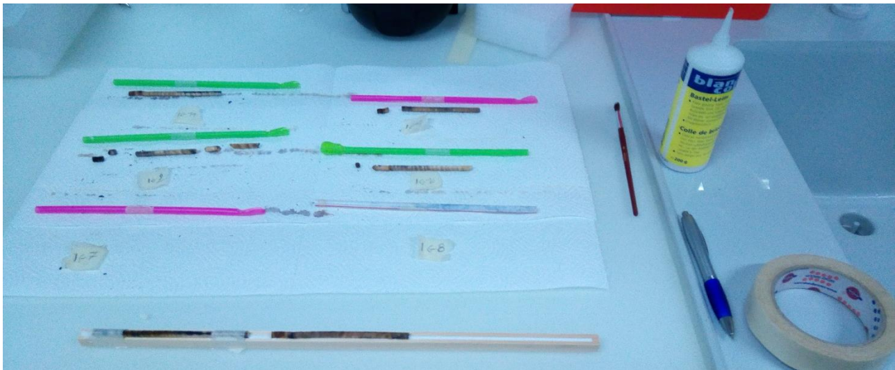
Figura 19 Fase di preparazione dei campioni alla lettura mediante posizionamento ed incollaggio delle carote nei supporti (Cadenazzo, Svizzera 2017)
