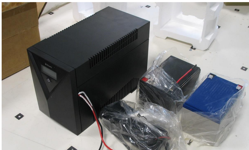
Figura 3.11: L'unità di continuità della nuova stazione intermedia con le due batterie aggiuntive.
