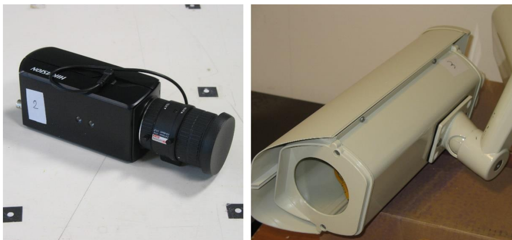
Figura 3.9: La telecamera e il suo involucro che andranno ad equipaggiare la nuova stazione intermedia.
