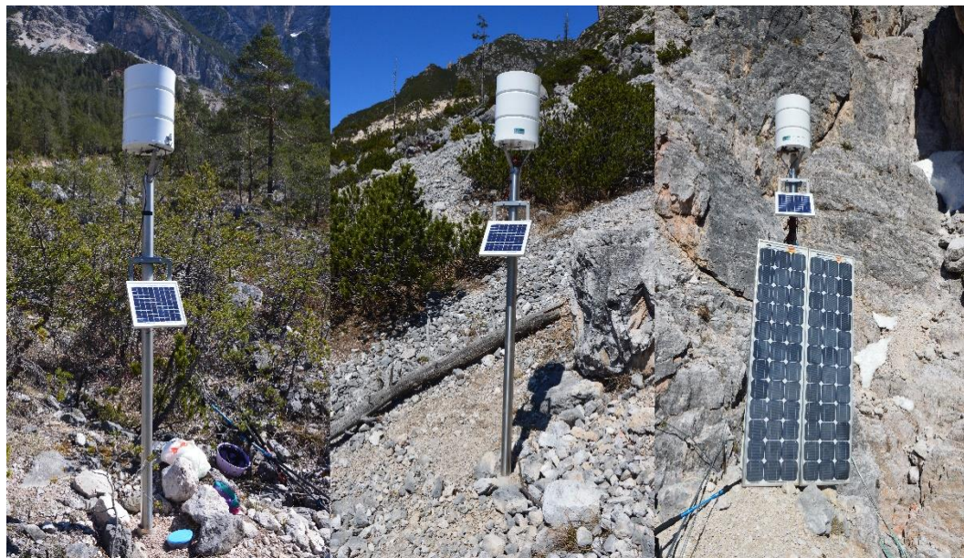
Figura 4.1: I tre pluviometri. Da sinistra: pluviometro di valle, pluviometro intermedio e pluviometro di monte.
