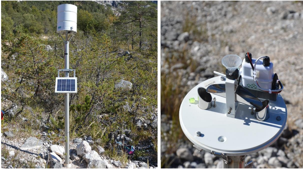
Figura 3.4: A sinistra il pluviometro intermedio con il suo pannello solare in posizione sul palo di sostegno in acciaio zincato; a destra lo stesso pluviometro aperto.
