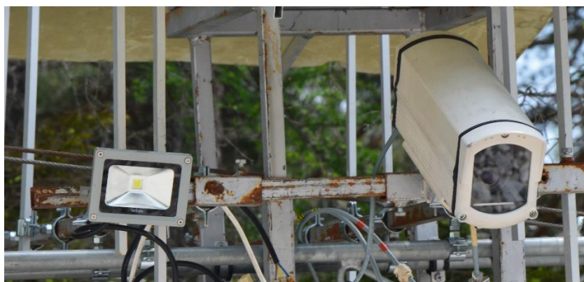
Figura 3.5: Il sistema di illuminazione e la telecamera in posizione all'interno del suo involucro.
