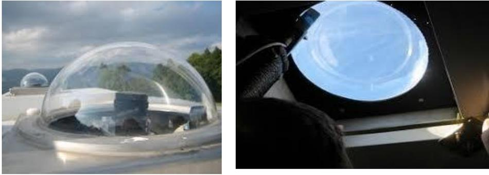
**Figura 5.3** A sinistra l'alloggiamento in cupola dello strumento (al centro è presente la AllSky-Camera e sulla destra l'SQM). A destra la vista interna alla cupola, (Web).
