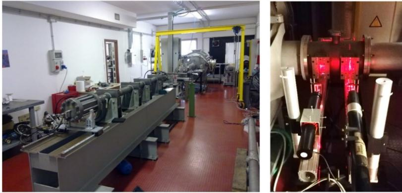
*Fig. 2.16 LGG del laboratorio CISAS di Padova (a sinistra) e sistema laser per la misura della velocità del proiettile (a destra)*
