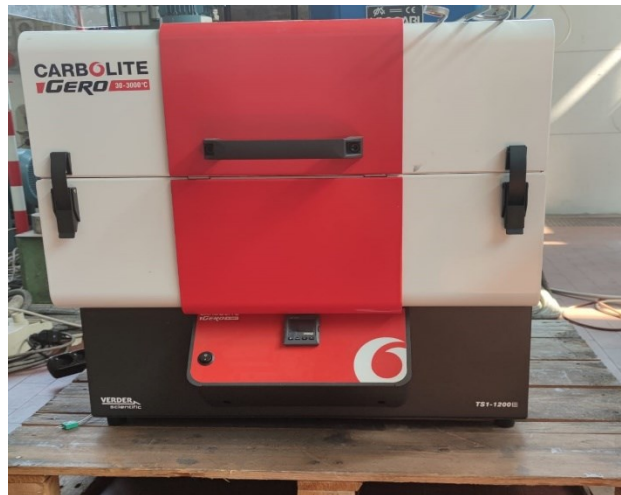
FORNACE UTILIZZATA PER IL TRATTAMENTO TERMICO DEI PROVINI
