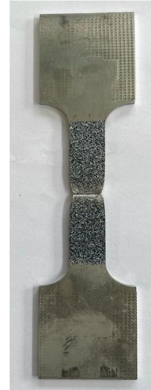
Provino post prova di trazione
